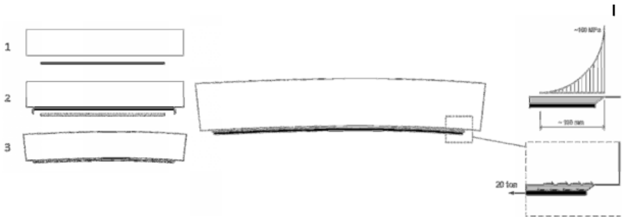
Figur 12. T.v. steg i samband med förspänning. T.h. höga skjuvspänningar i änden på laminat i samband med förspänning och vidhäftning.
