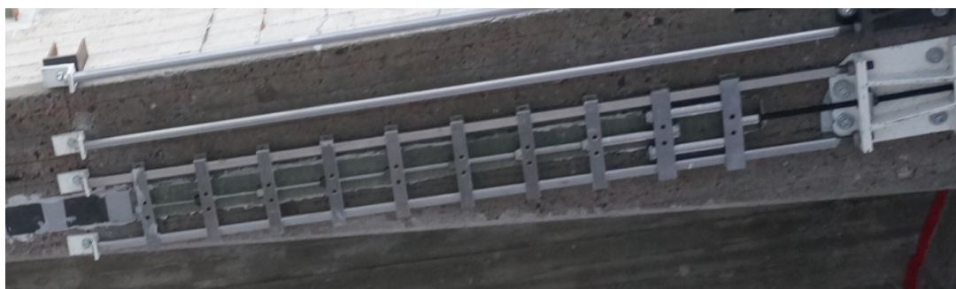
Figur 24. Aktiv del av förspänningsanordning, precis låst efter påförd spännkraft om 100 kN.
