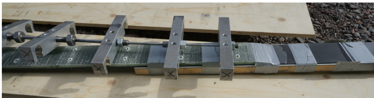
Figur 16. Övre, glasfiberlaminat, med monterade muttrar, limmad mot ena änden på kolfiberlaminat. Förankringsanordning monterar mot glasfiberlaminat med två skruvar. Nedre, förankringsanordning fastskruvad i glasfiberlaminat.
